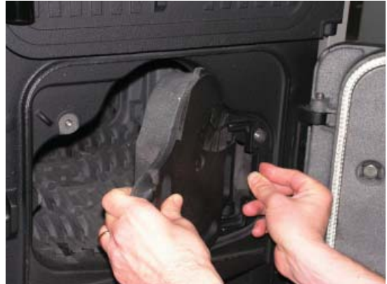
Fig. 14 Remove the grille
